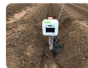
圃場に設置された 土壌水分計端末
